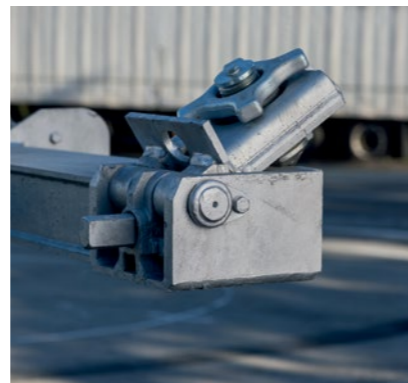
Klappverriegelung als PIN-Verriegelung für Tunnelcontainer am Frontbalken.
